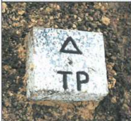
BFP/TP Granitpfeiler 16 cm x 16 cm (auch bodengleich)*
