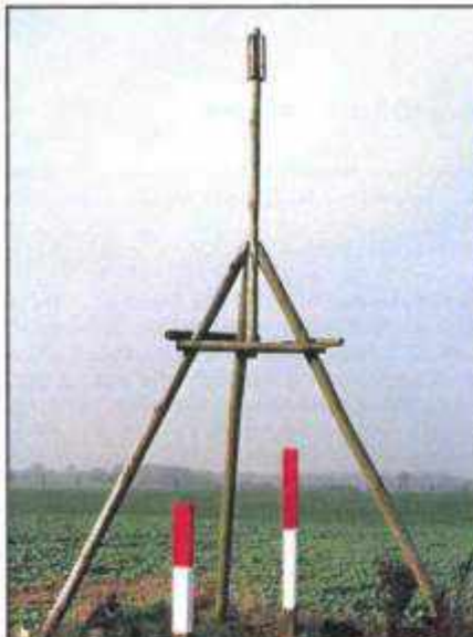
TP Granitpfeiler 16 cm x 16 cm mit Schutzsignal und Schutzsäulen
